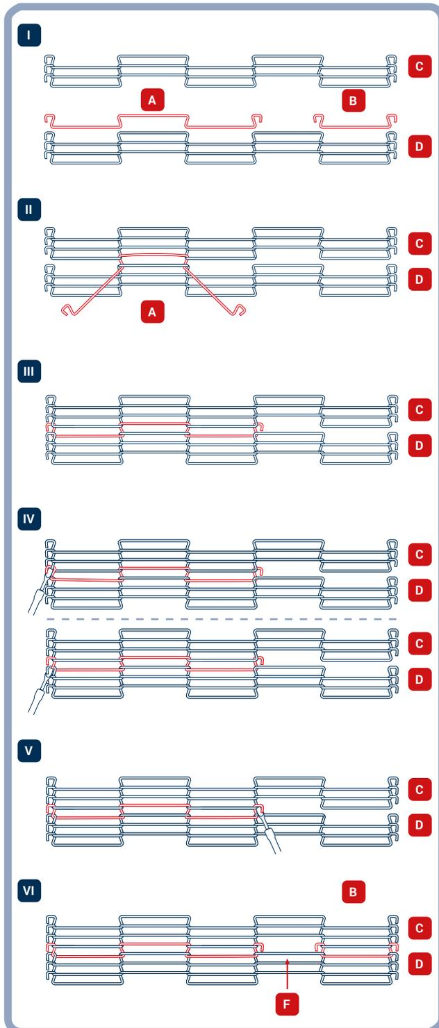
Les ECO-clips sont des éléments de jonctionnement pour les grilles à fils entrelacés ECO.
